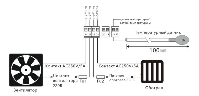
**ВАЖНО!** Если мощность вентилятора или нагревательной пластины превышает емкость контакта (или мощность управления), необходимо добавить промежуточное реле, иначе есть риск перегорания контактов.
