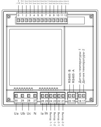
Подключение контроллера осуществляется к клеммам **Ua, Ub, Uc** и **N**. **Ub** и **Uc** это не только сигнал напряжения, но и входы собственного питания регулятора.
