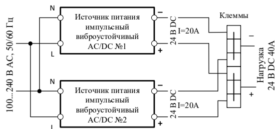
Параллельное подключение двух источников питания
